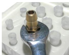
⇒ ・外径六角の2面へねじりの力を伝達 ・工具位置が上下にずれると六角形状から外れて大変危険です
